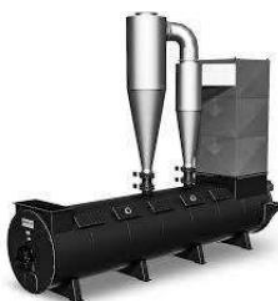
Figura 3: Forno de resfriamento contínuo.
