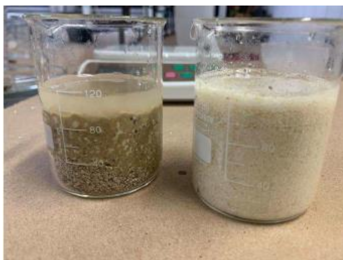
Figura 8: Amostras das areias sanitárias após o teste de saturação com jato d'água.
