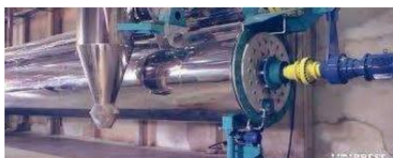
Figura 1: Forno contínuo a vapor para torrefação.
