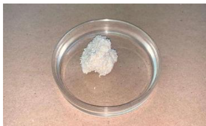
Figura 6: Amostra da areia sanitária (100% mandioca) após o teste do torrão.
