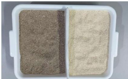
Figura 5: Amostras de areia a base mandioca e a base de argila.
