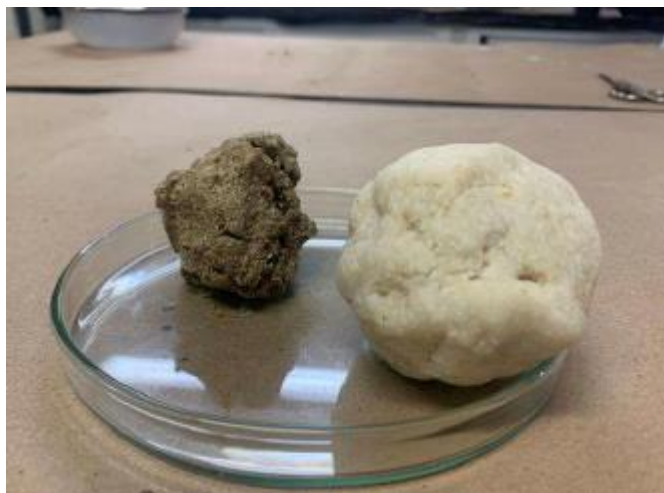
Figura 9: Aspecto da massa formada após o teste de jato d'água.
