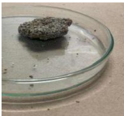
Figura 7: Amostra da areia sanitária (100% esmectita) após o teste do torrão.
